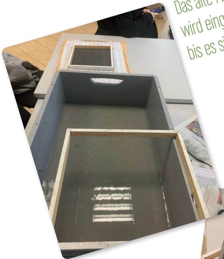
In selbstgebauten Rahmen wird das aufgelöste Papier verteilt und getrocknet.
